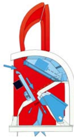
Optische Systeme sortieren Störstoffe pneumatisch aus.
